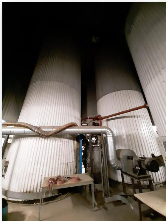
Les différentes matières premières sont incorporées et mélangées dans le malaxeur pour obtenir de l'asphalte (durée de mélange environ 60 secondes). Les produits enrobés chauds sont alors acheminés vers des silos au moyen d'un bac mobile. Ils seront chargés finalement sur des camions et transportés vers les chantiers de mise en œuvre.
