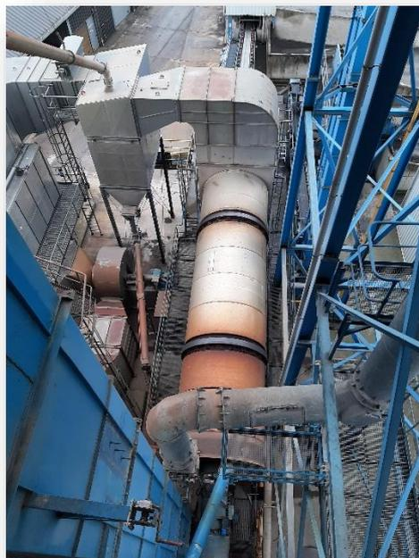
Les minéraux chauds et séchés sont acheminés vers une installation de tamisage via un élévateur où ils seront tamisés suivant les fractions désirées. Les différentes fractions sont alors prélevées, pesées et acheminées vers un malaxeur afin d'être mélangées avec le bitume et le filler.
